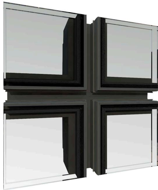
Sistema de fachada estrutural (Vidro Exterior Colado), composto por prumos e travessas com 55mm de largura e envergadura variável. Apresenta uma superfície exterior plana constituída por uma quadrícula de vidros sem alumínio visível, sendo estes fixos nos perfis que constituem os quadros através de um processo de colagem executado por vidreiras especializadas.
