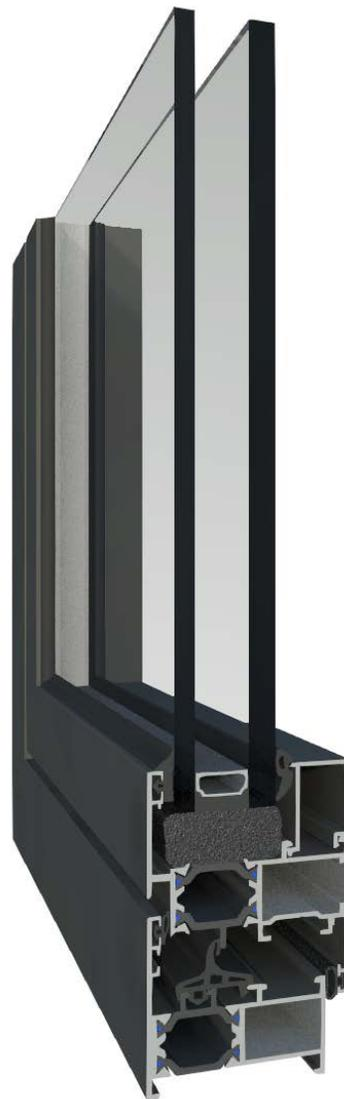
Série de batente com rotura térmica, composta por semi-perfis de alumínio extrudido, unidos com barras de poliamida de 24 mm, reforçada com fibra de vidro.
