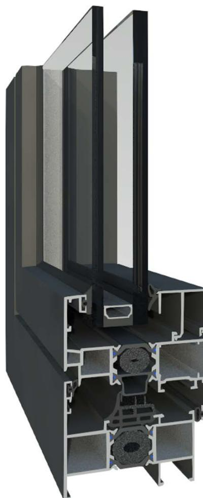
Série de Batente com rotura térmica, composta por semi-perfis de alumínio extrudido, unidos com barras de poliamida de 24mm, reforçada com fibra de vidro.
