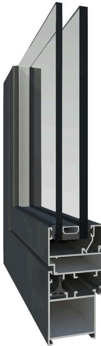
Sistema de batente, com vedação central, composta por aros fixos com 45mm e aros móveis com 52mm.
